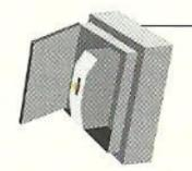
**Llave térmica:** debemos tener instalada una protección de este tipo dentro del taller para evitar que un cortocircuito afecte a otras habitaciones.
