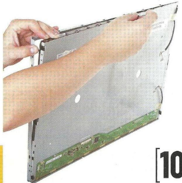
“ UN CABLE MAL CONECTADO PUEDE HACER QUE EL MONITOR ENCIENDA PERO QUE SE MUESTREN LÍNEAS EN LA PANTALLA. ”
