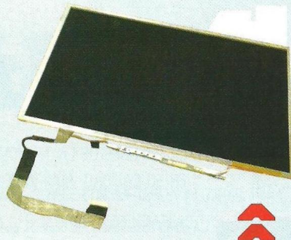
**LCD con inverter.** Los monitores LCD de notebooks tienen el inverter integrado.
