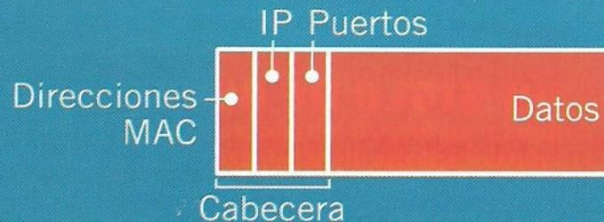
A TRAVÉS DE LA SIGUIENTE REPRESENTACIÓN GRÁFICA, SE EXPLICA EL COMPLEJO MECANISMO MEDIANTE EL CUAL UN SIMPLE PAQUETE DE RED ES ENVIADO DE UN DISPOSITIVO A OTRO.
