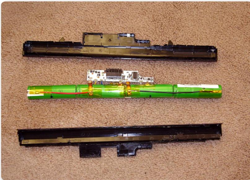
► **Figura 34.** En la imagen se aprecia la parte interna de una batería para laptop, observamos la presencia de cuatro celdas.
