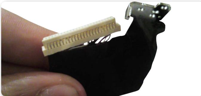
► **Figura 18.** Los conectores LVDS se utilizan a menudo en pantallas LCD para enviar señales de baja tensión y lograr su funcionamiento.
