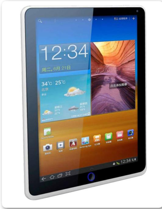
**Figura 6.** Las actuales pantallas para tabletas electrónicas, incluyen la tecnología de panel IPS para mejorar su ángulo de visión.
