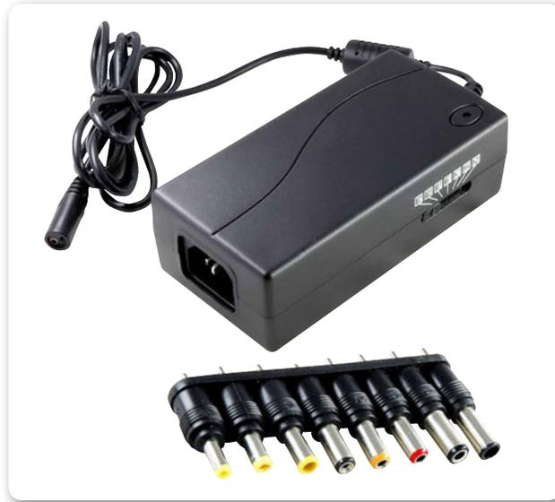
► **Figura 26.** Un cargador universal es imprescindible para el técnico de equipos portátiles.
