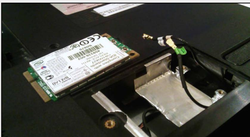
Los módulos de memoria RAM, al igual que las conexiones miniPCI, poseen un par de seguros que mantienen insertos sus adaptadores, por lo que, para su expulsión, es recomendable liberar dichos seguros de forma manual. Habitualmente las MiniPCI, integran este mecanismo.
