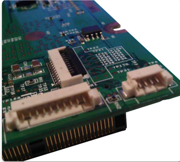
► **Figura 21.** Las ranuras **SPKR** soportan cuatro contactos de conexión, dos para cada uno de los altavoces.
