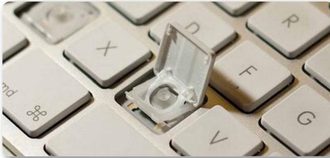
► **Figura 20.** La imagen que vemos aquí nos muestra la parte interna de una tecla del dispositivo QWERTY.
