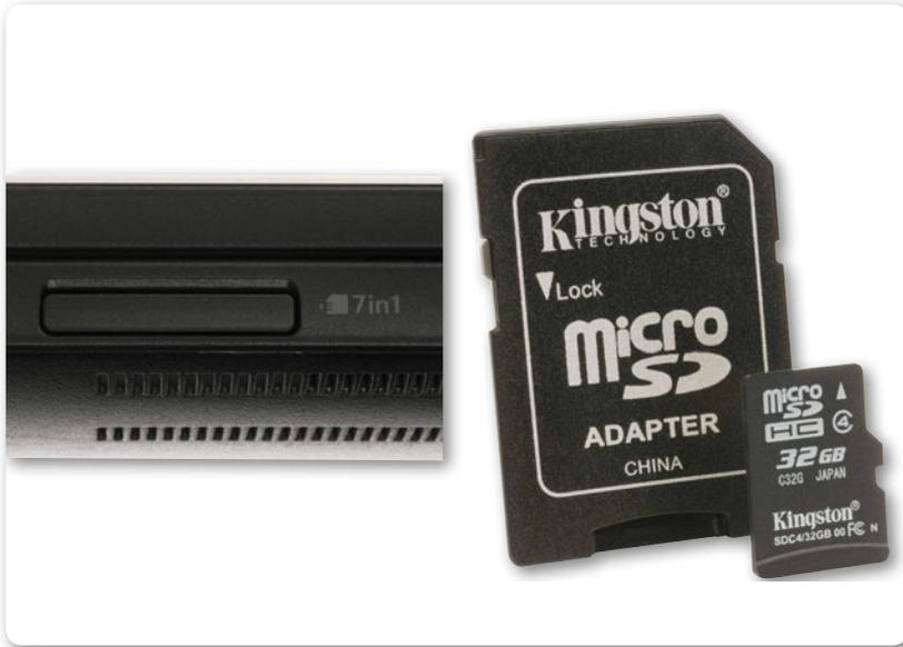
► **Figura 8.** En la imagen se aprecia la forma que tiene un multilector de tarjetas de memoria y una memoria micro SD.
