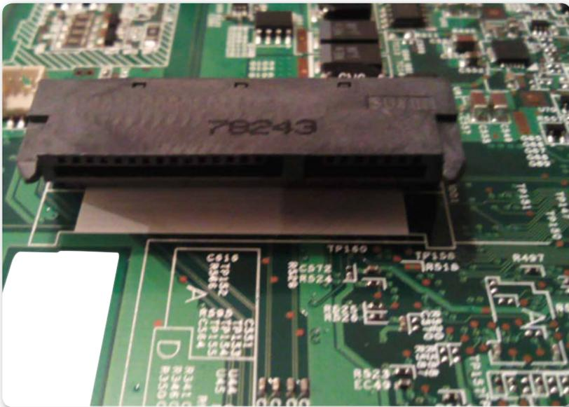
► **Figura 30.** En la imagen se aprecia el conector SATA ubicado en el motherboard de una PC portátil.
