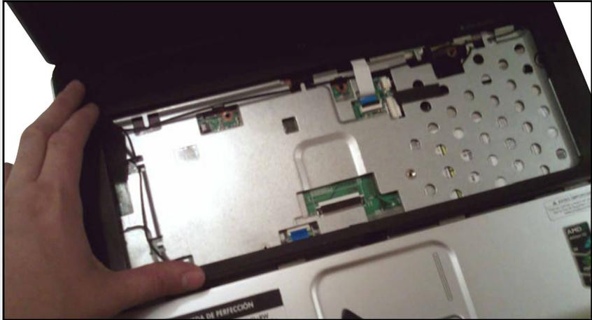
Una vez retirado el teclado de la PC, hay que pasar a retirar el tablero, que contiene elementos como: los paneles exteriores de los altavoces, las muñequeras, algunos botones y el propio touch pad; este último está conectado internamente a través de un cable a la placa madre. Se recomienda no jalar la cubierta del tablero hacia el exterior sin antes haberla liberado de cualquier cable o conector interno.
