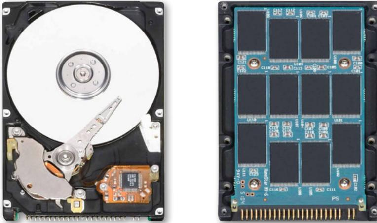
► **Figura 28.** Los discos **HDD** (a la izquierda) tienen una arquitectura de diseño muy distinta de los nuevos **SSD** (a la derecha).
