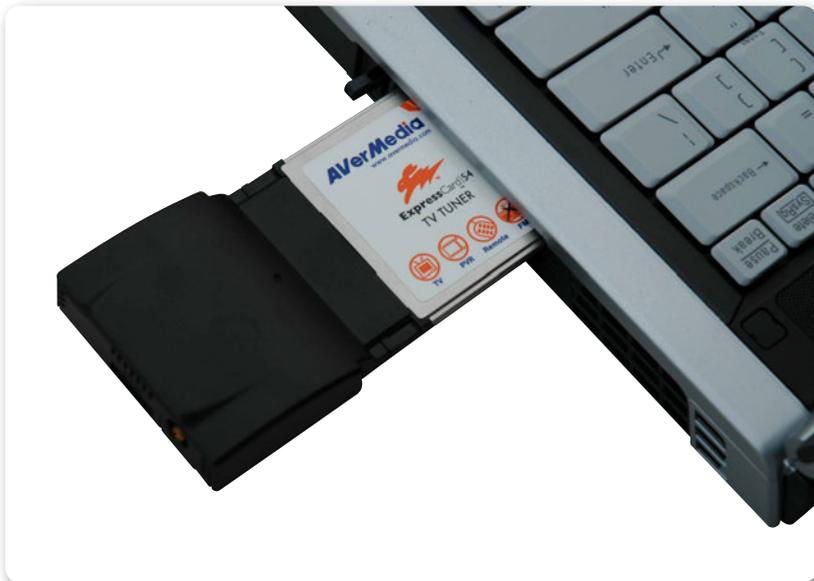
► **Figura 5.** Las PC Card a menudo se conectaban en ranuras especiales, ubicadas en algún panel de la PC portátil, llamadas ranuras **PCMCIA**.
