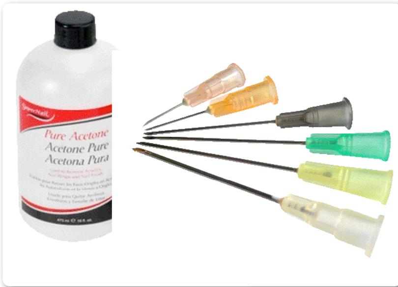
► **Figura 9.** Una forma muy efectiva para poder abrir un cargador de laptop se logra con un aplicador y algunos mililitros de **acetona**.
