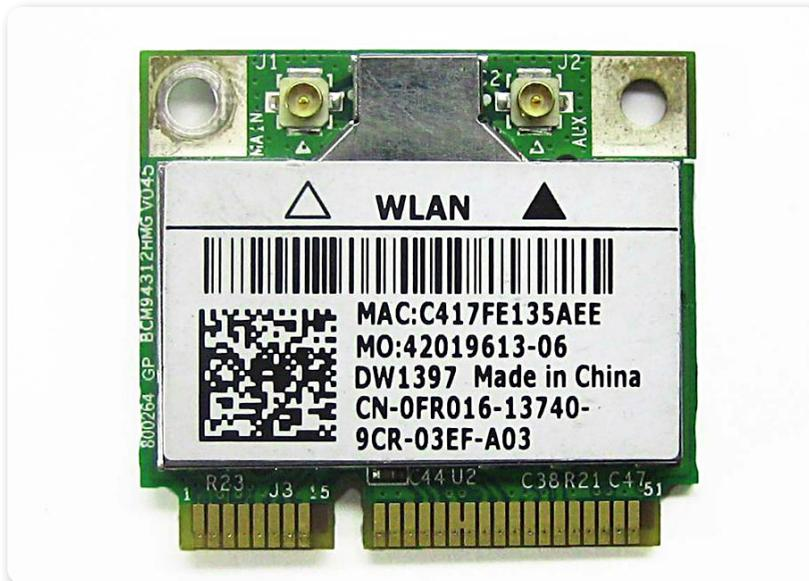
► **Figura 36.** Las tarjetas WiFi para equipos portátiles se encuentran integradas en los portátiles actuales.
