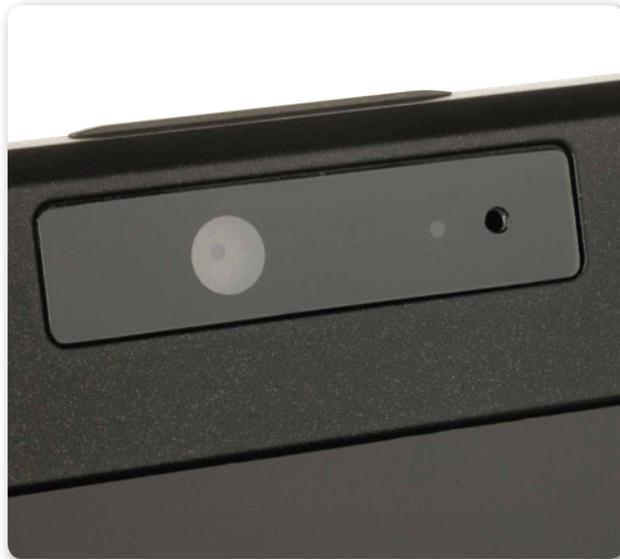
► **Figura 13.** Actualmente, la pantalla de un equipo portátil moderno integra (de izquierda a derecha) una webcam, un LED indicador y un micrófono.
