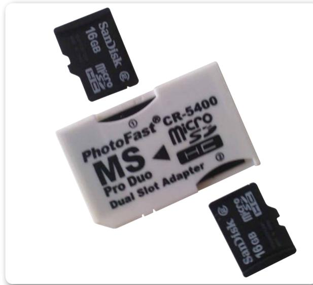
► **Figura 7.** Los adaptadores pasivos suelen usarse para adaptar la dimensión de una memoria con las especificaciones de ancho y grosor estándar.
