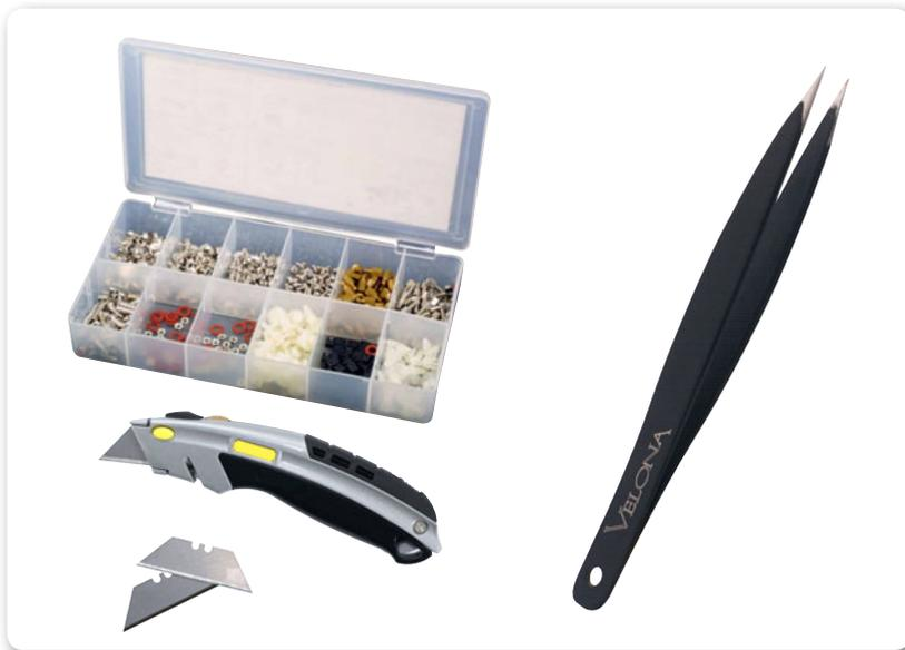
► **Figura 2.** En la figura se aprecian las herramientas básicas utilizadas para el desensamble y ensamble de una computadora portátil.
